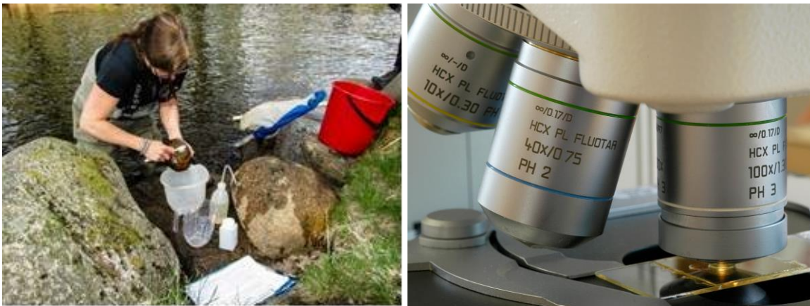
Figur 17. Provtagning av kiselalger görs i första hand genom borstning av stenar varefter kiselalgspreparat framställs och analyseras i ljusmikroskop med 1000 gångers förstoring (objektiv 100x), © Medins Havs och Vattenkonsulter AB-Part of Sweco.
